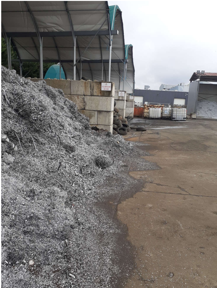
Figure 4: Tournures métalliques stockées en dehors du box prévu à cet effet
